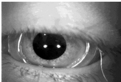
Obr. 13: Kontaktní čočka s drátek vedoucí k měřícím přístrojům ( zdroj: Takao, 2004).
