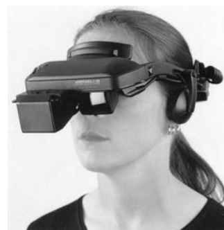
Obr. 14: Příklad stolního a na hlavě nošeného trackeru (zdroj: Duchowski, 2007).
