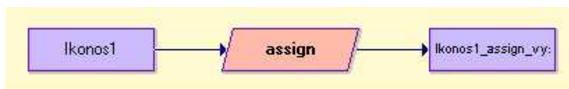
Obr. 15 Macro Modeler, zleva vstupní data, operace, výstupní data se zkráceným popiskem
