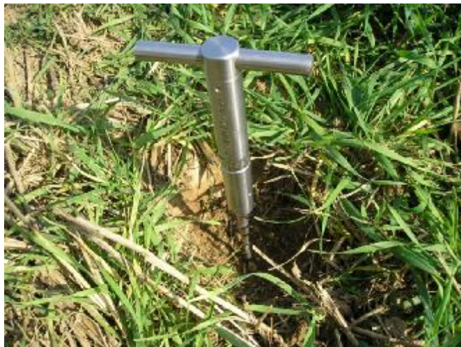
Obr. 7: Field Inspection Vane Tester na měření smykového napětí
