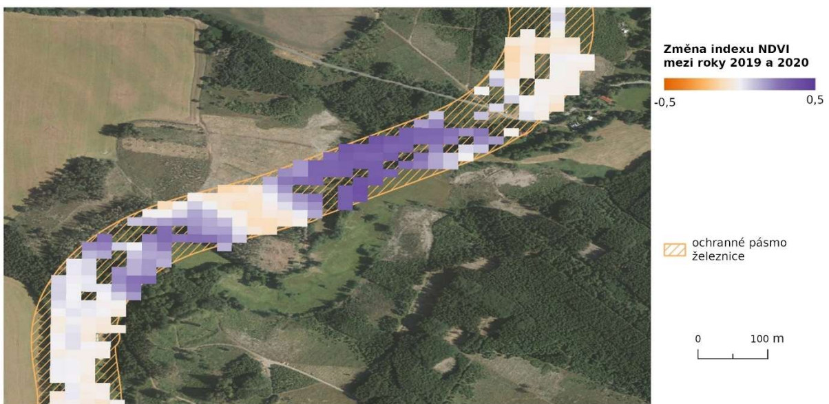
Obr. 3 Ukázka vyhodnocení meziroční změny NDVI indexu pro stanovení zdravotního stavu vegetace (vlastní zpracování)
