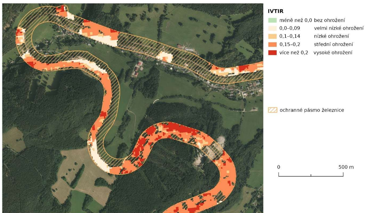
Obr. 33 Kategorizovaný index IVTIR dle úrovně ohrožení mezi roky 2019 a 2020 na vybraném území
